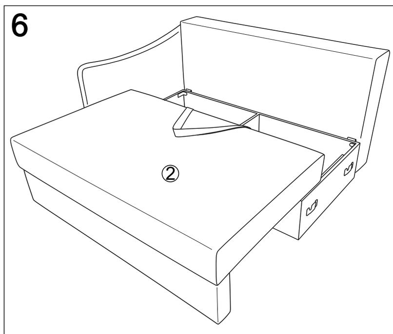
Установить сидение ② на короб совмещая опорные ролики на направляющие планки установленные в коробе.
