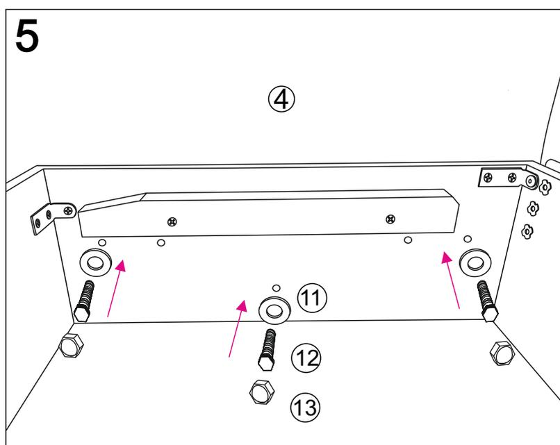
С помощью шайб ⑪ и болтов ⑫ закрепить подлокотник ④ с внутренней стороны короба в соответствующие отверстия. На болты ⑫ установить колпачки ⑬
