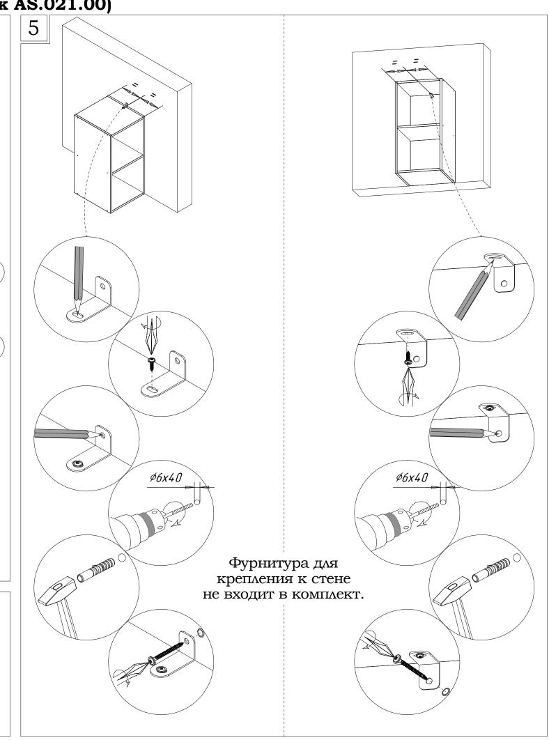
Инструкция по сборке стеллажа 2 секции Scout (Скаут) 36,8\*72,1\*39 (стеллаж AS.021.00)
