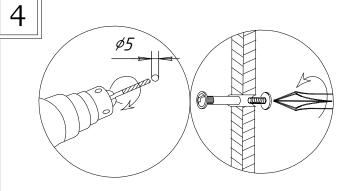
Стеллажи можно соединять между собой при помощи межсекционных стяжек. Для этого необходимо просверлить отверстия \$5 мм в соседних стенках, предварительно выровняв изделия.
