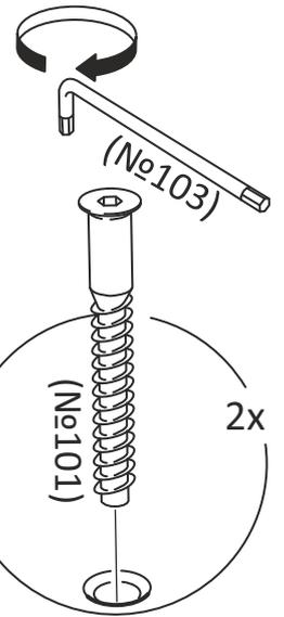
Установить пеленальную накладку на комод, согласно выбранной схеме ниже, и закрепить в торец крышки с помощью евровинтов 5x50 (№ 101) (рис. 3). Установить на евровинты заглушки (№ 105).
