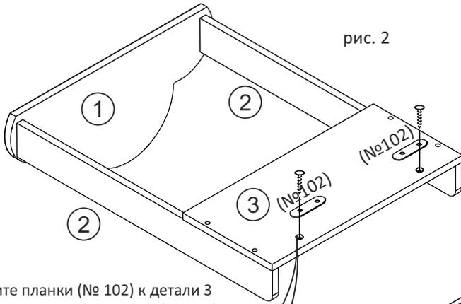
Закрепите планки (№ 102) к детали 3 с помощью саморезов 3,5x16 (№ 104) (рис. 2).
