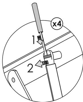
Для снятия газового амортизатора:
