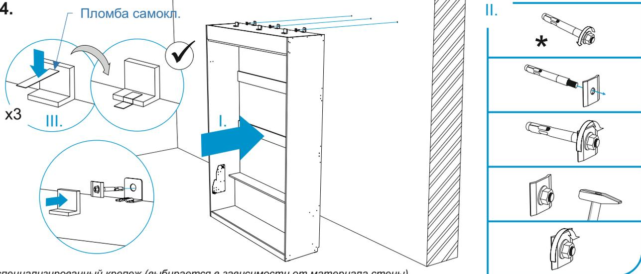
\* специализированный крепеж (выбирается в зависимости от материала стены)
